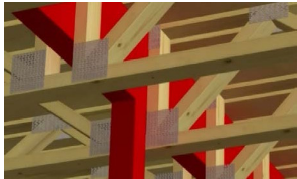
Dersom innvendig bæring er nødvendig, kan denne legges skjult inne i konstruksjonen.
